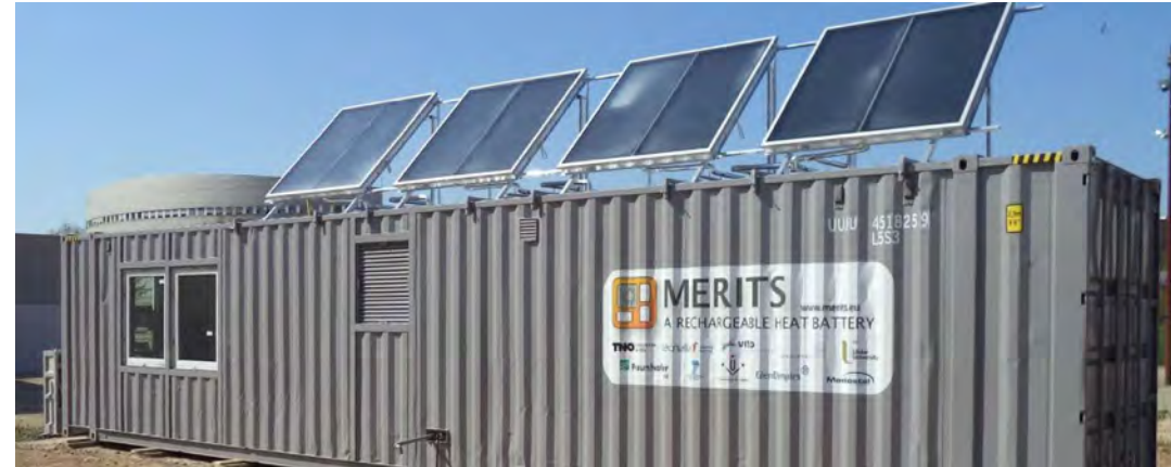
Proefopstelling warmteopslag in zout – Foto TNO
