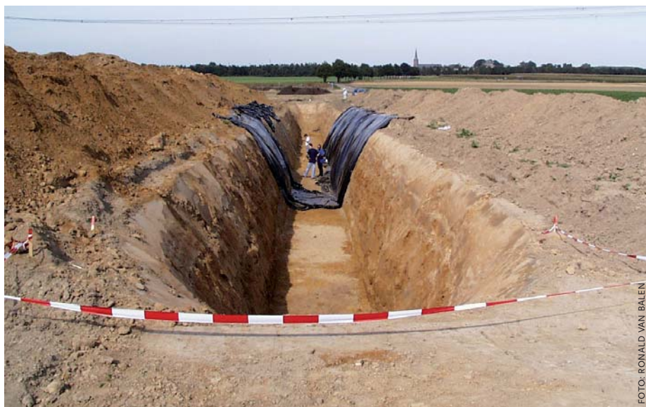
De sleuf over de Feldbissbreuk bij Born: 80 meter lang en ruim 4 meter diep.
